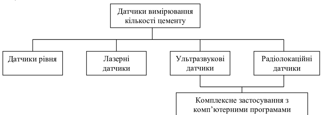
Рис. 1.5. Датчики вимірювання кількості цементу на складі [37]
