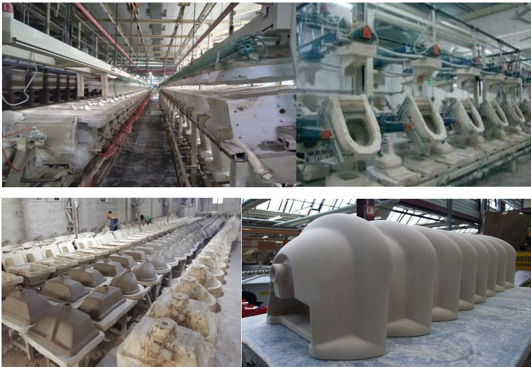
Рис. 1. Застосування гіпсових форм у виробництві санітарної кераміки
