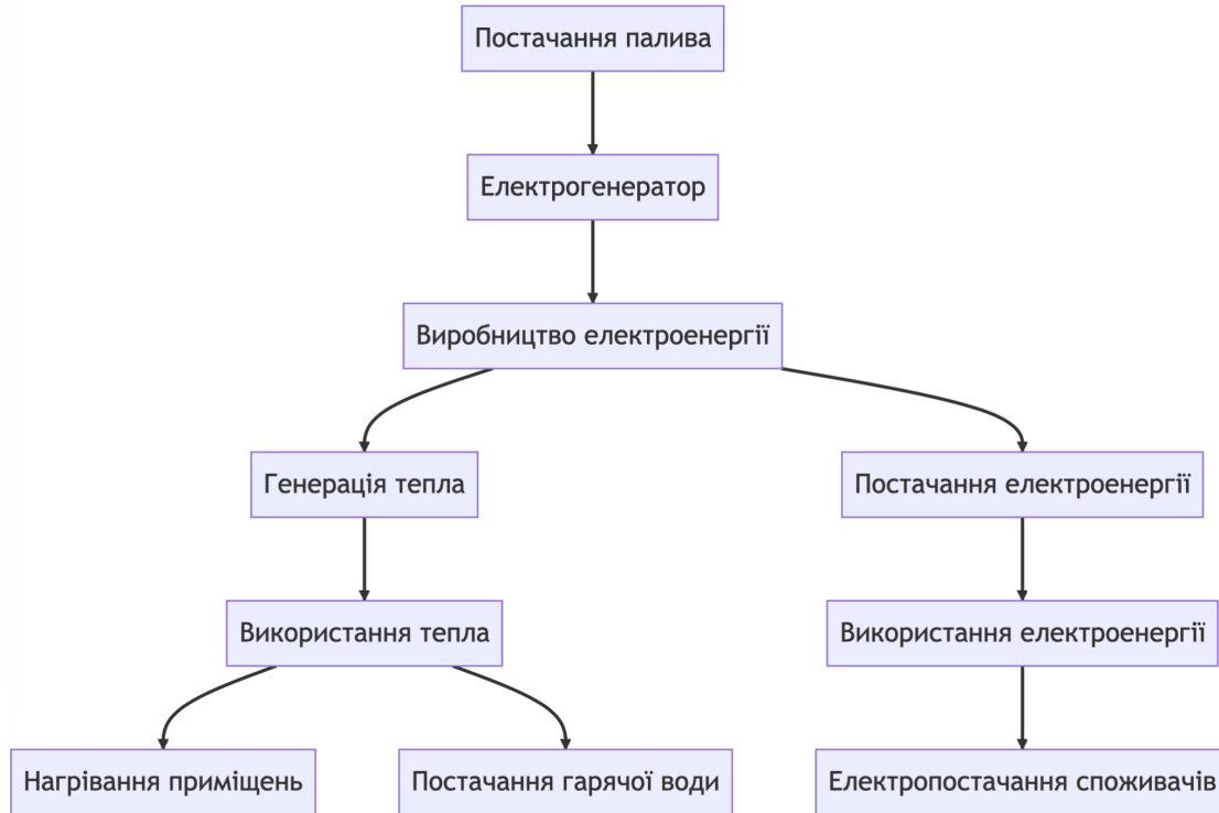
Рисунок 1.2 – Схема когенераційної системи на основі електрики
