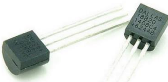
Рисунок 2.2.1 – Давач температури DS18B20
