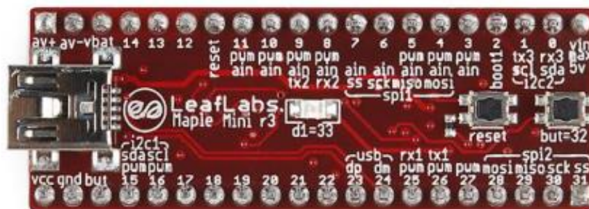
Рисунок 2.1.5.1 – Мікроконтролер Maple Mini
