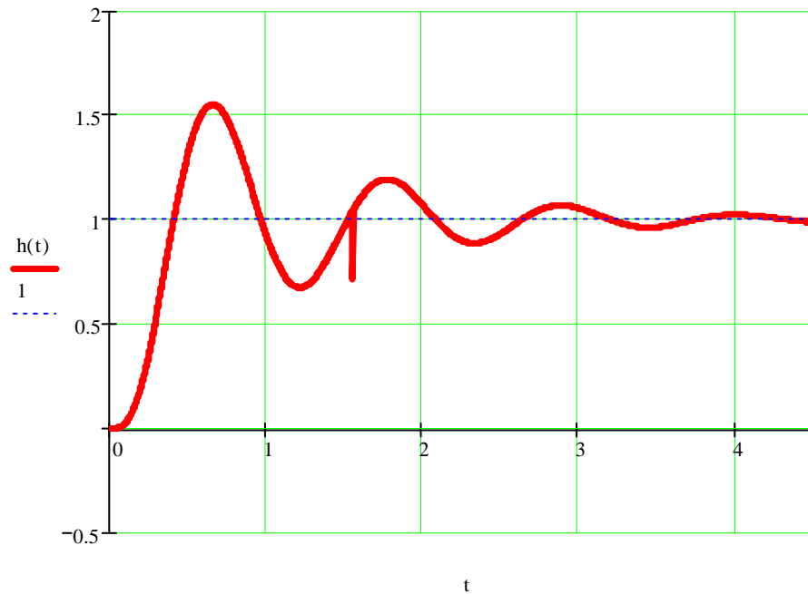
Рисунок 3.12 - Крива перехідного процесу вихідної замкнутої САР
