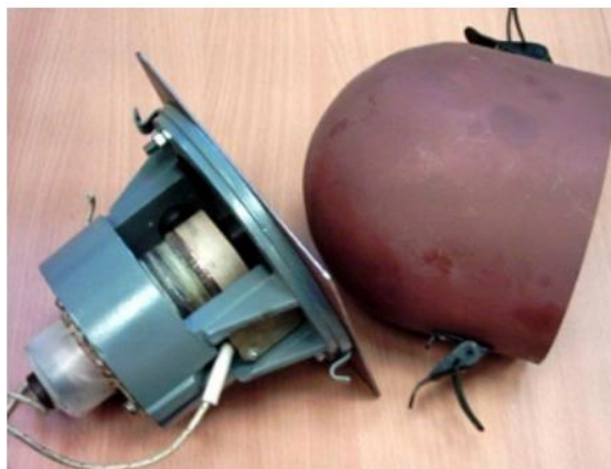
Рисунок 2.7 - Тахогенератор постійного струму ТС-1МУХЛ4
