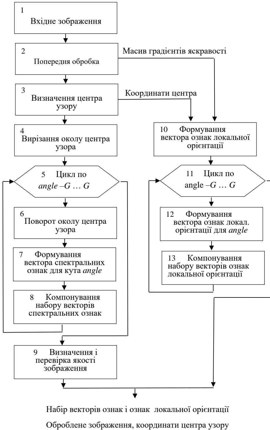
Рисунок 3.4 – Блок-схема алгоритму генерування наборів векторів ознак перед ідентифікацією
