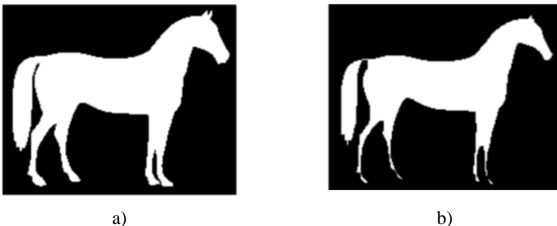
Рисунок 2.3 – Приклад виконання операції ерозії: вхідне зображення (a) результат операції ерозія (b)
