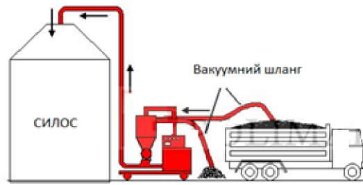
Рисунок 1.10 – Розвантаження з автотранспорту зерна на склад за допомогою вакуумного шлангу
