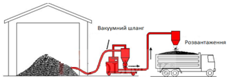
Рисунок 1.11 – Завантажування зерна на автотранспорт з складу за допомогою вакуумних шлангів
