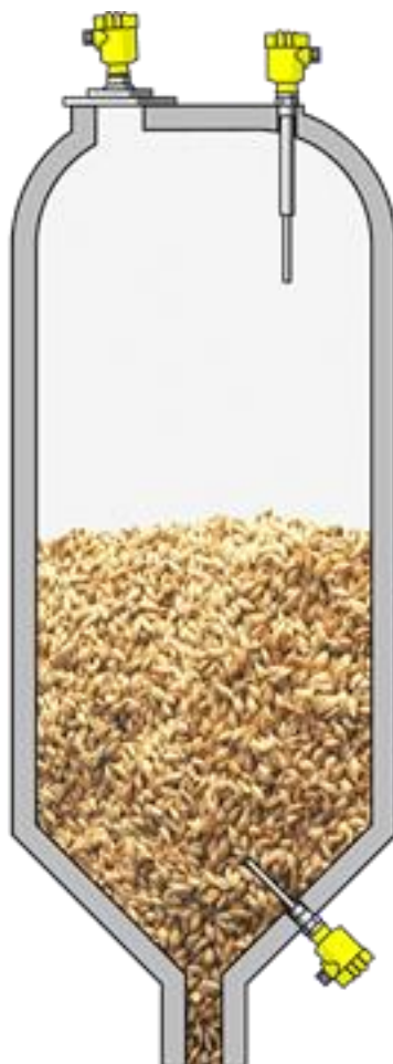
Рисунок 2.10 – Принцип роботи радарного рівнеміра сипучих продуктів
