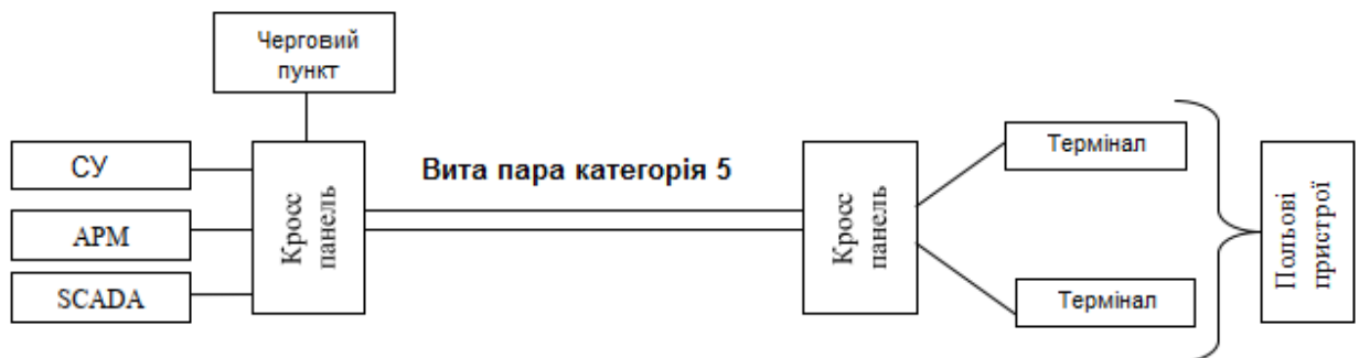
Рисунок 1.5 – Принципова схема підключення пристроїв до локально розподільної мережі ПС
