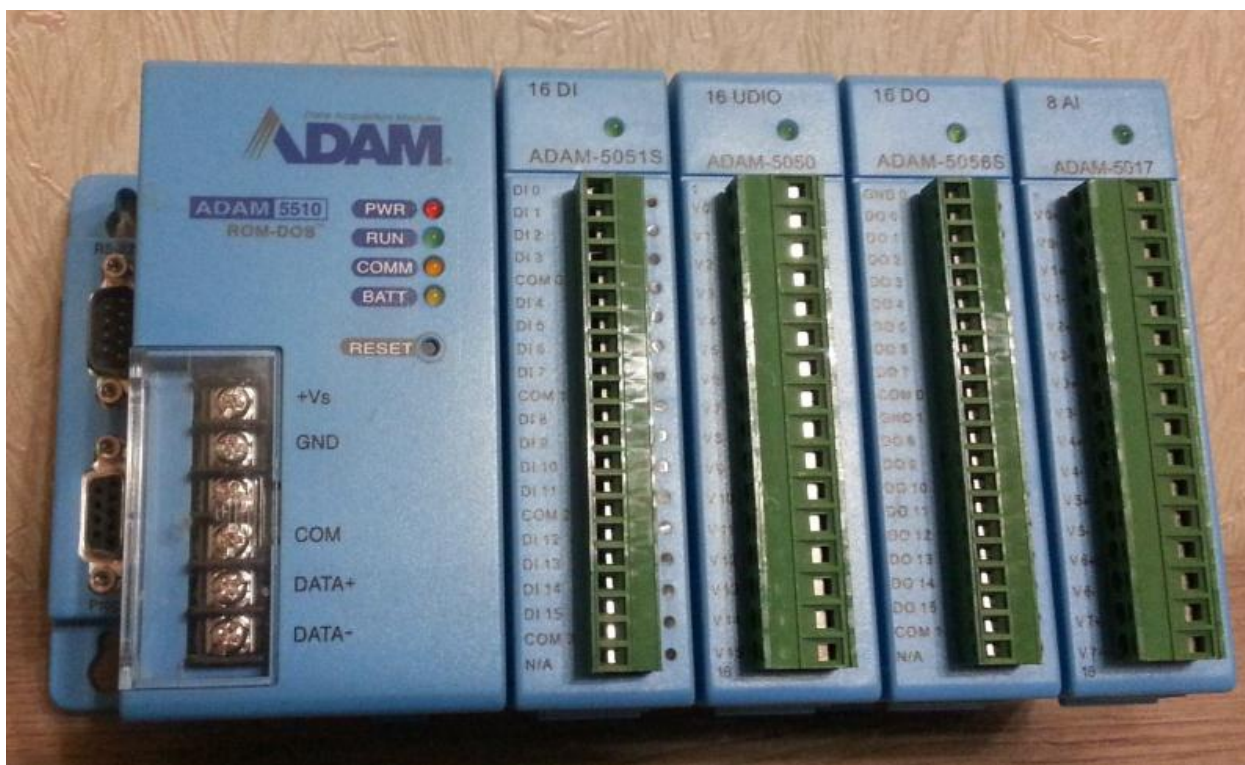
Рисунок 3.4 – Програмований контролер ADAM–5510E/TCP.
