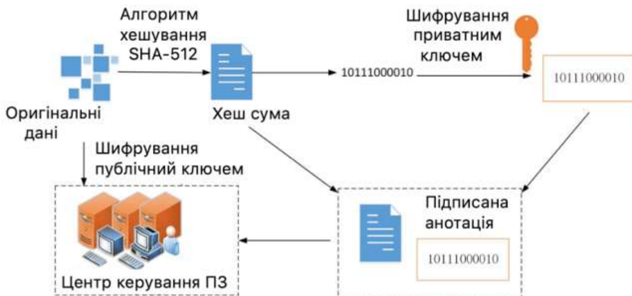
Рисунок 3.5 – Процес шифрування та передачі даних IoT
