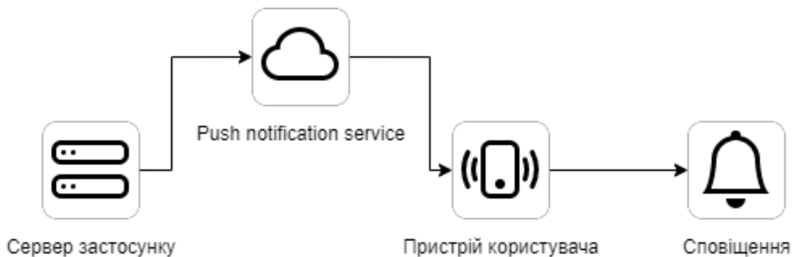
Рисунок 2.2 – Маршрут PUSH-повідомлення від сервера застосунку до користувача
