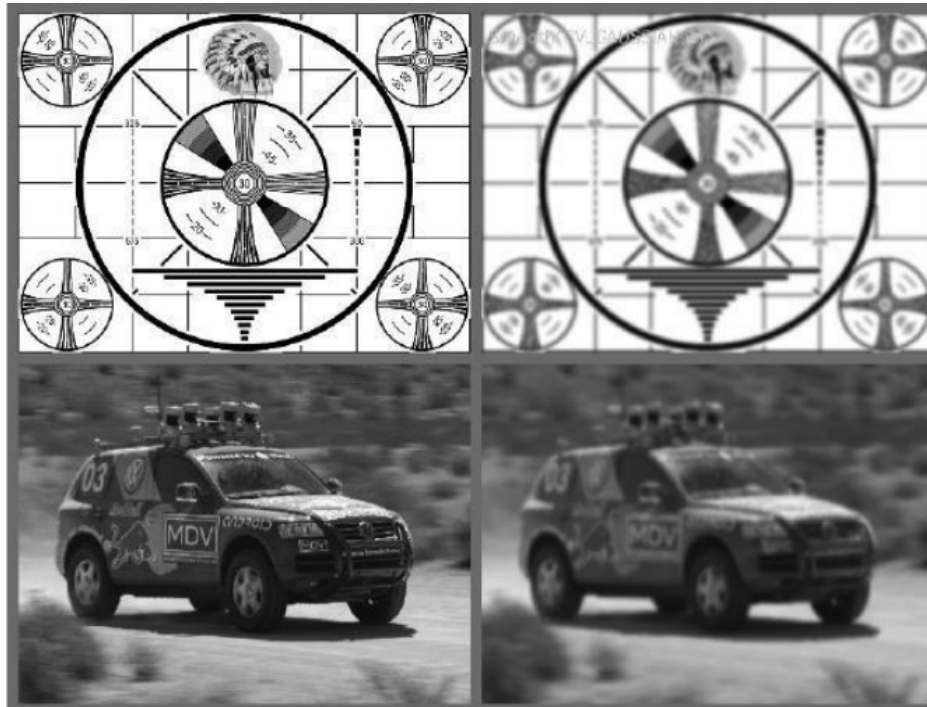
Рисунок 2.8 - Результат застосування фільтра Гауса.
