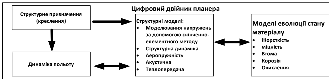
Рисунок 1.3 - Елементи цифрового двійника планера літака
