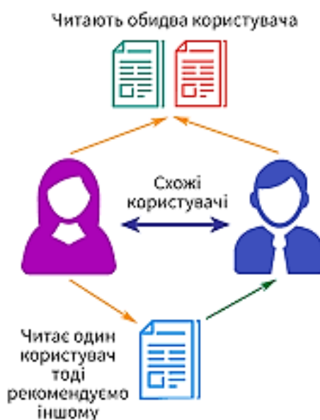
Рисунок 2.1 – Схематичне відображення колаборативної фільтрації
