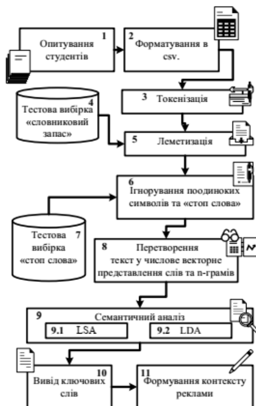
Fig. 1. Структура інтелектуального методу формування рекламного контенту закладів вищої освіти на основі семантичного аналізу
