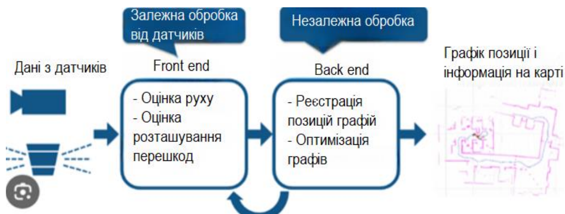
Рисунок 1.4 – Принцип побудови карти простору за технологіями SLAM
