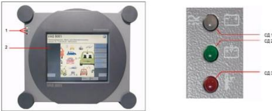
Рис. 3.1 Лицьова сторона тестера: 1 - світлодіоди; 2 - сенсорний екран
