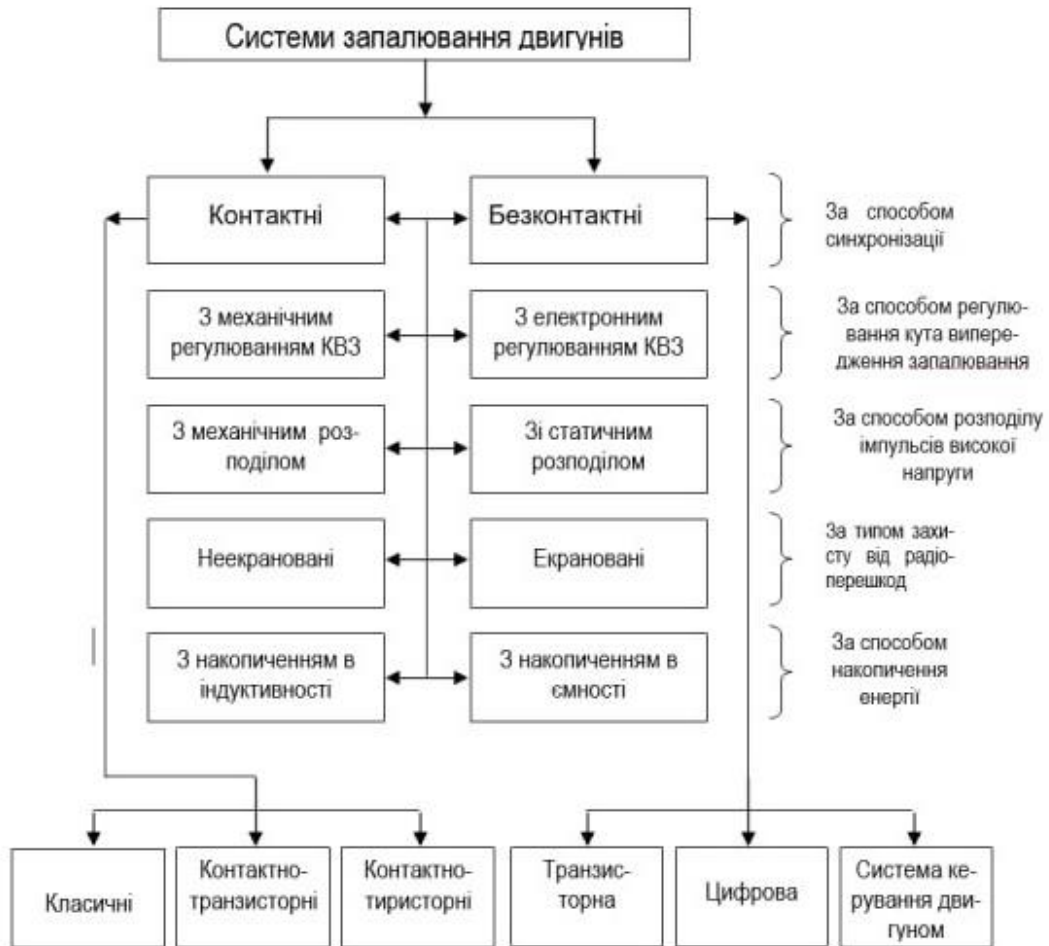
Рис. 1.5. Класифікація систем запалювання автомобільних бензинових двигунів
