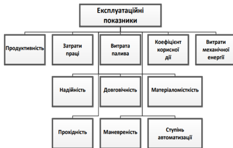
Рисунок 3.2 Експлуатаційні показники для рішення задачі вибору автомобіля оптимальної вантажопідйомності
