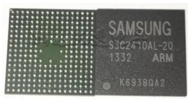
Рисунок 3.5 - Samsung ARM9 S3C2410
