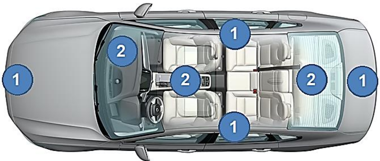
Рисунок 2.11 – Розташування антен СБДА
