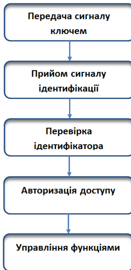
Рисунок 2.2 – Принцип роботи СБДА
