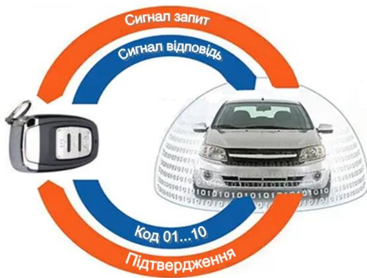
Рисунок 2.1 – Процес обміну даними в СБДА
