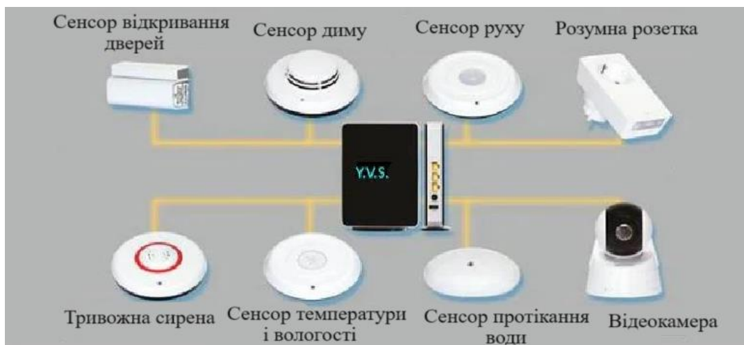
Рисунок 1.5 – Різновид сенсорів системи управління та автоматизацією будинку
