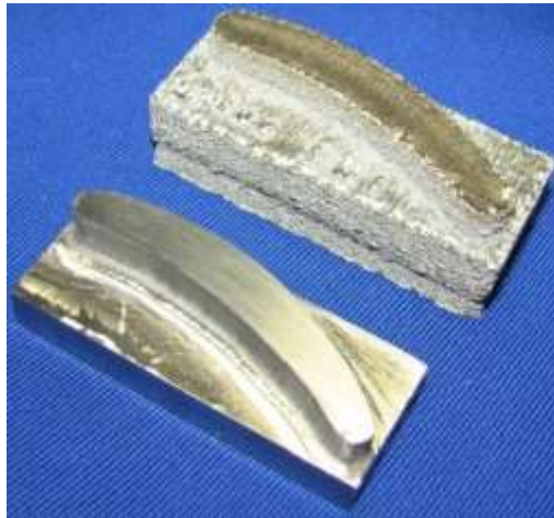
Рис. 2.7. Лопатка газотурбінного двигуна створена 3D-друком[8]
