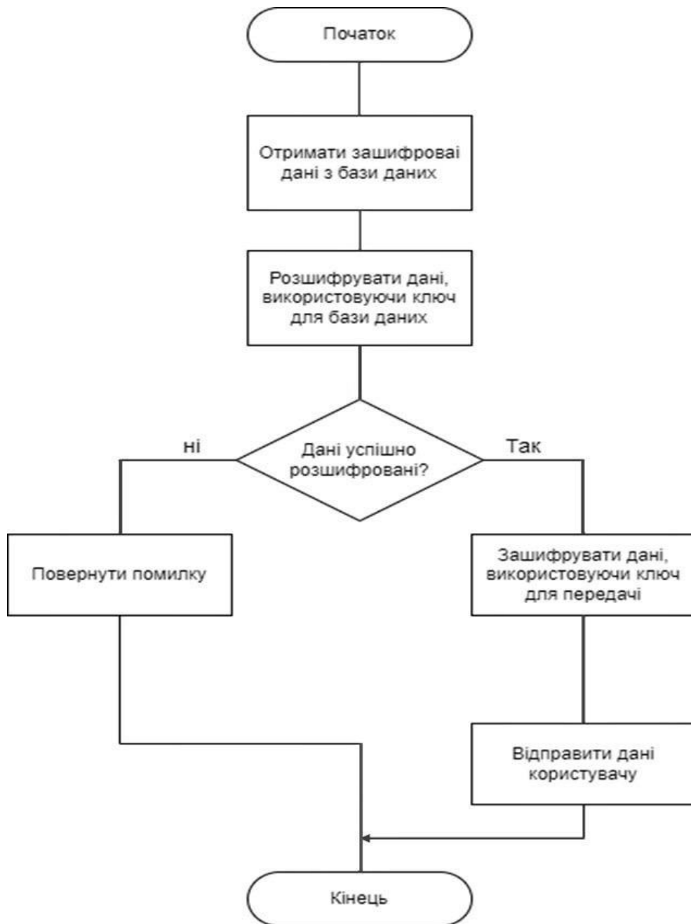
Рисунок 2.3 – Блок-схема алгоритму відправки чутливих даних клієнту зі сторони сервера
