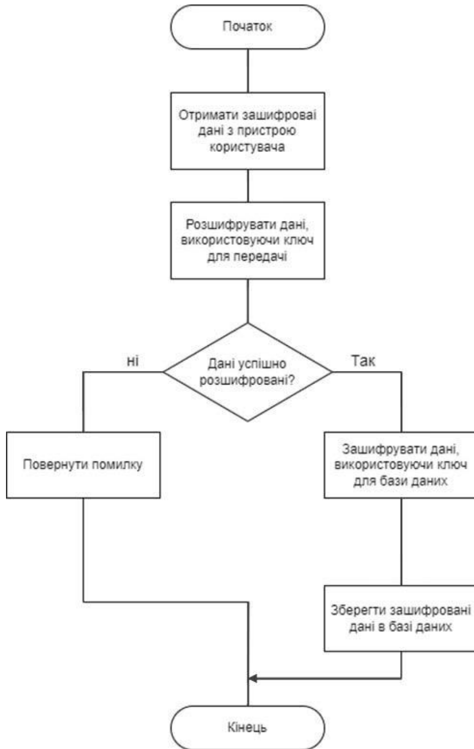
Рисунок 2.2 – Блок-схема алгоритму збереження чутливих даних у базі даних
