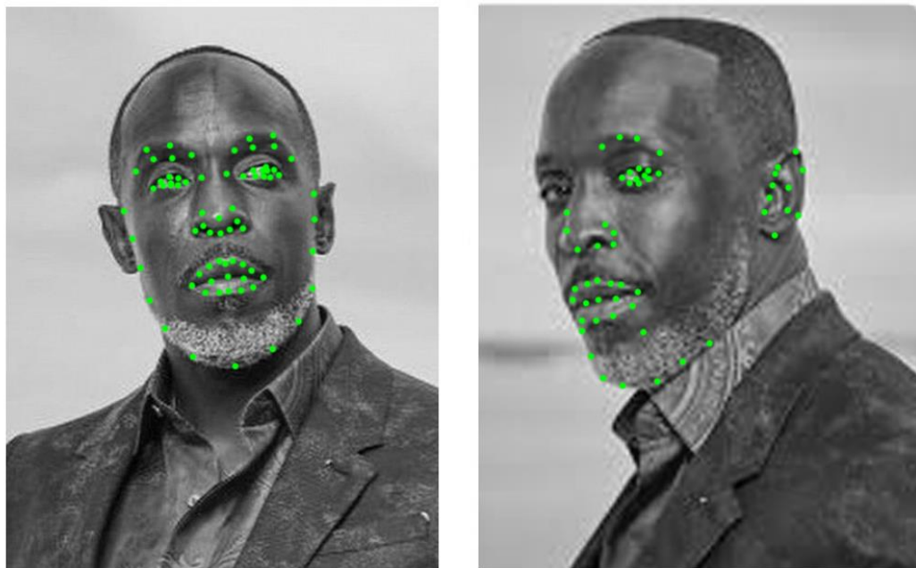
Рисунок 1.4 – Виявлення антропометричних точок обличчя на фотографіях анфас та у профіль
