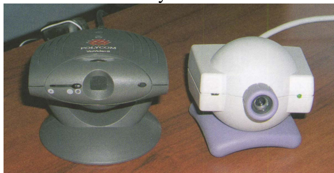
Рисунок 1.5 – аудіо-відеокодек ViaVideo компанії Polycom (зліва) і відеокамера Philips терміналу Cruiser 384 (справа)
