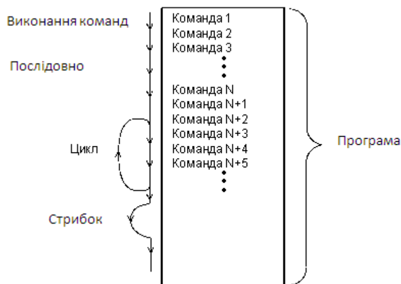
Рисунок 1.9 - Програмний обмін інформацією
