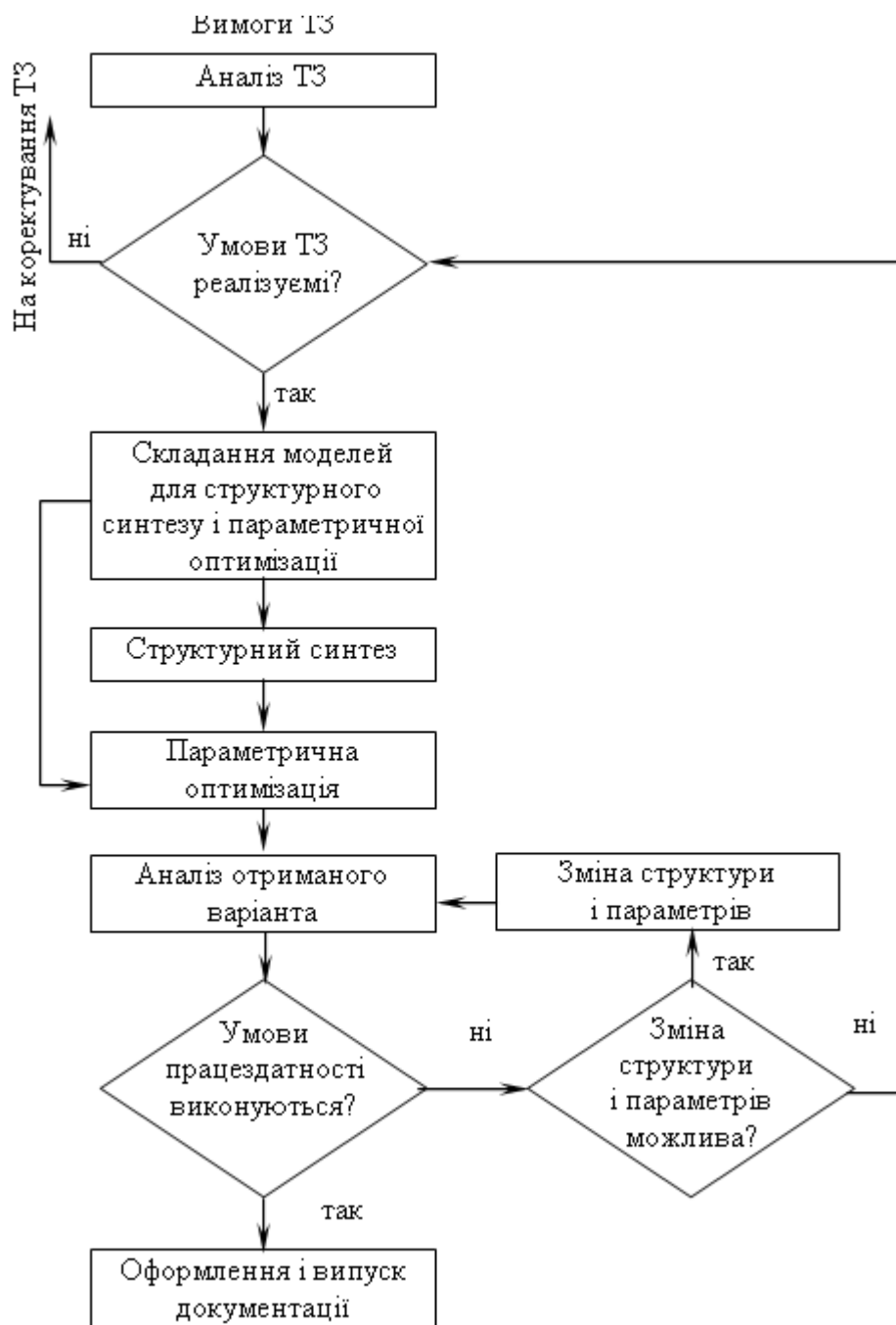
Рисунок 3.2 – Блок-схема процесу проектування МПС та пристроїв
