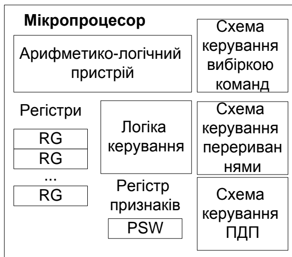
Рисунок 1.5 - Приклад структури простого процесора
