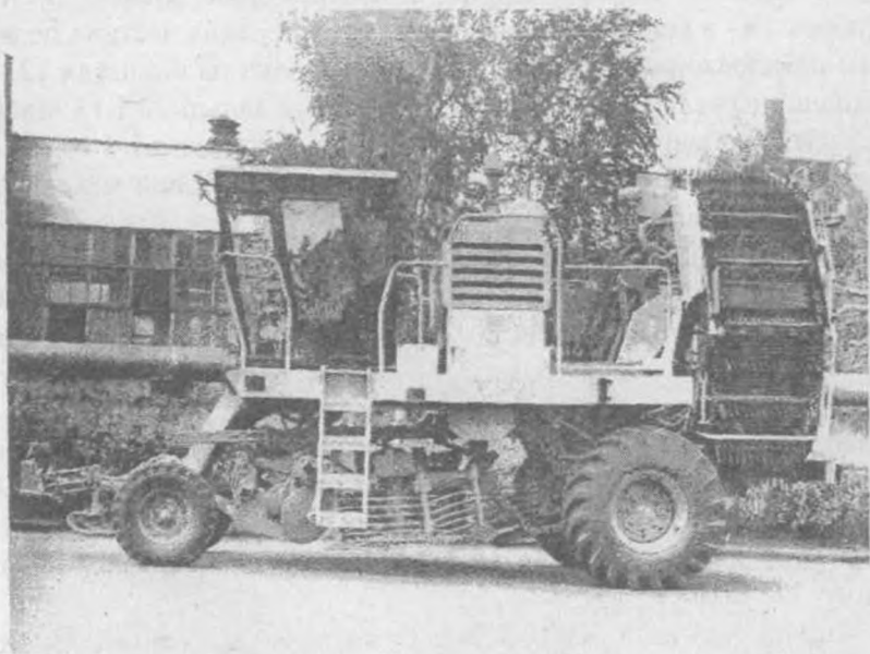
Рис. 3.9- Экспериментальна коренезбиральна машина КС-6В з двоторним викопувально-очисним пристроєм
