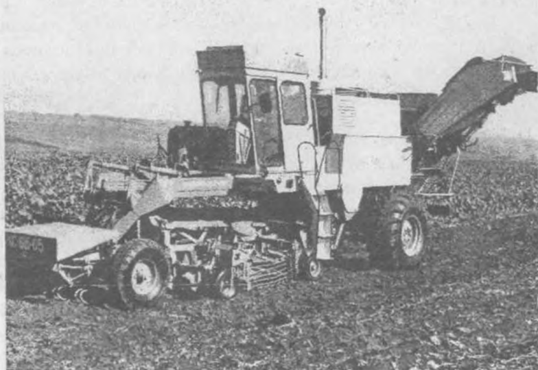
Рис.3.10- Самохідна коренезбиральна машина КС-6В-05 з трироторним сепаруючим пристроєм
