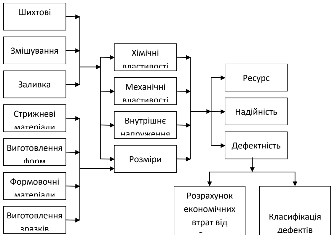
Рис. 3.4 Організаційна модель групи факторів, що забезпечують якість цегли на філії МПП «Теренок», Вишнівецький цегельний завод.
