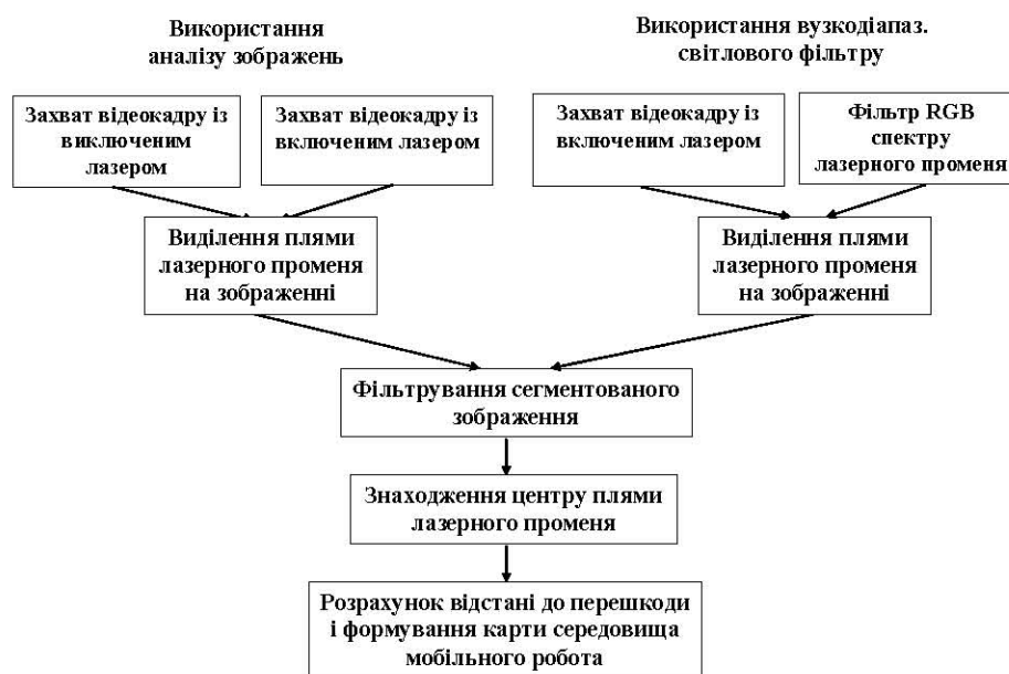
Рис. 2.23. Схема порівняння підходів сегментації плями структурованого світла із використанням аналізу зображення і вузькодіапазонного світлового фільтру
