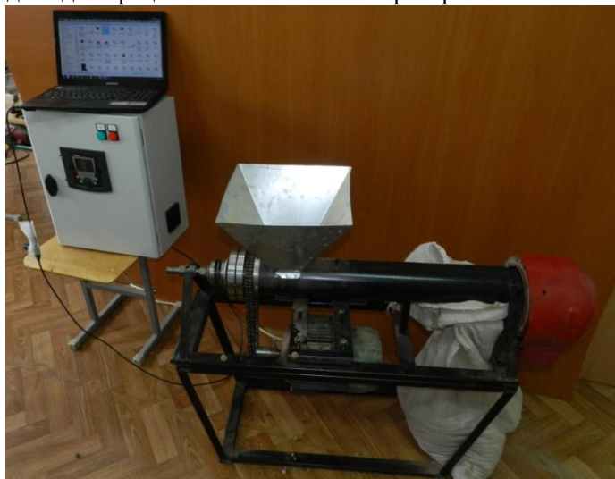
Рис. 3. Загальний вигляд стенду для дослідження шнекового транспортера із запобіжним пристроєм
