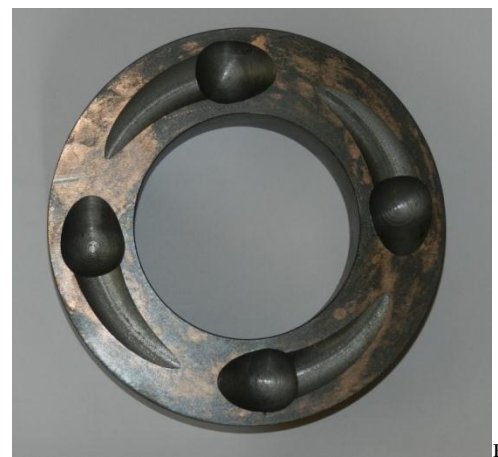
Рис. 1. Конструктивна схема запобіжного пристрою (а) та загальний вигляд робочої поверхні ведучої півмуфти: б – модель, виконана в КОМПАС 3D; в – загальний вигляд виготовленої півмуфти
