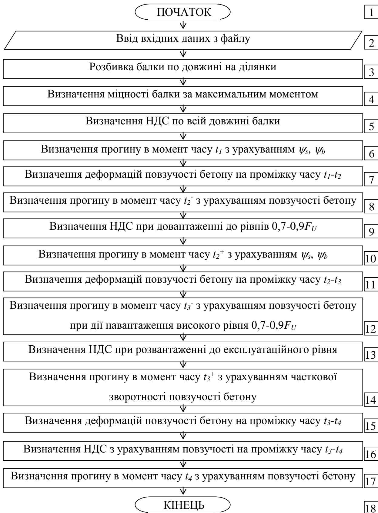
Рис. 4.10. Блок-схема алгоритму програми визначення НДС та прогинів балки при довантаженні балки до рівнів 0,7-0,9F_U
