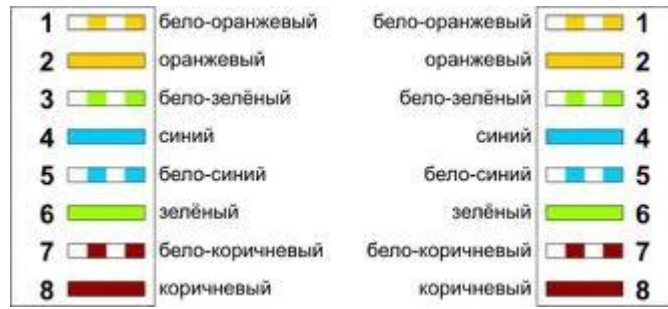
Рисунок 3.7 - Схема обтиску кабеля Витя пара
