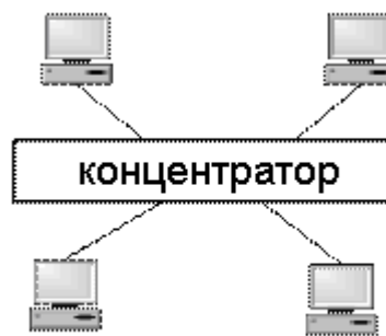
Рисунок 1.4 - Топологія «пасивна зірка»
