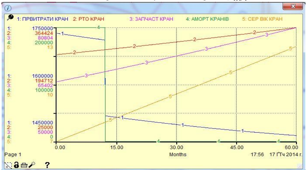
Рис. У.2. Динаміка прямих витрат на експлуатацію будівельної техніки при досягненні нормативного терміну служби баштових кранів ( T_{Поч}^c = 7 )
