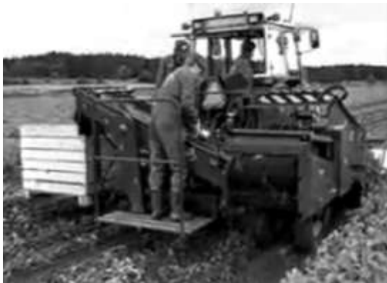
Рис. 7. Картоплезбиральний міні-комбайн SUPER MIDI фірми «Juko» (Фінляндія), навісний 1-рядний з бічним підкопуванням, вивантажує бульби у контейнер (можлива поставка з платформою для розфасування у мішки або з транспортером для вивантаження у транспортний засіб)
