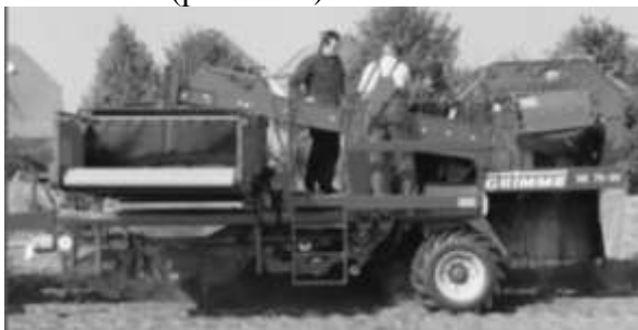
Рис. 8. Картоплезбиральний комбайн SE 75-20 фірми «Grimme» (Німеччина) 1-рядний з бункером на 2,0/2,3т (можлива поставка з платформою для розфасування у мішки)
