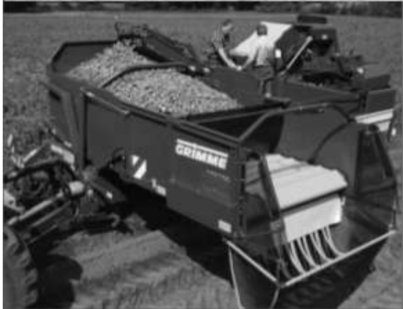
Рис. 9. Картоплезбиральний комбайн SE 75/85-55 фірми «Grimme» (Німеччина) 1-рядний з бічним підкопуванням і бункером на 5,8т
