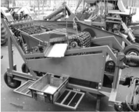
Рис. 4. Картоплезбиральний міні-комбайн КСК-1 «Кабан» фірми «Ижевский завод тепловых машин» (Росія), навісний 1-рядний копач-збирач картоплі з вивантаженням бульб у сітки чи ящики
