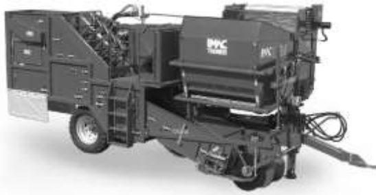
Рис. 10. Картоплезбиральний комбайн 7580 RB25 фірми «ІМАС» (Італія) 1-рядний з бічним підкопуванням і бункером на 2,5/3,0т
