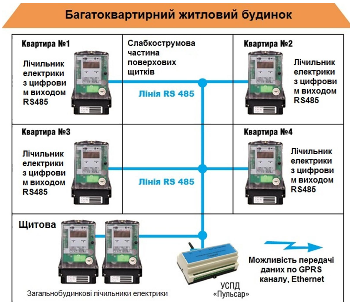
Рисунок 2.10 - Автоматизований збір даних лічильників електроенергії з цифровим виходом
