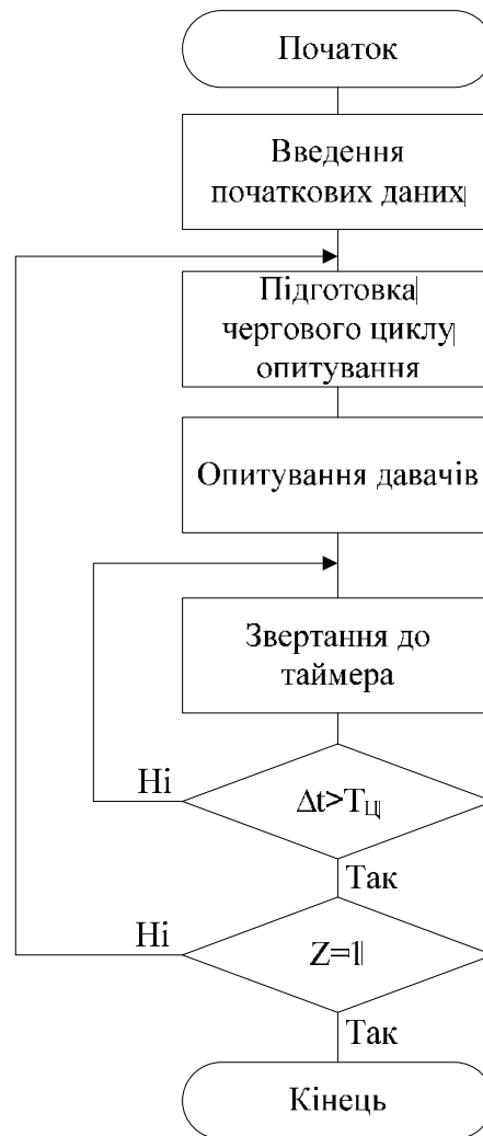
Рисунок 2.1 – Блок-схема алгоритму циклічного опитування датчиків (1-й етап)
