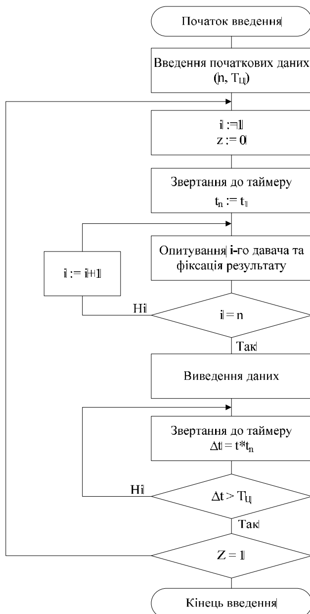
Рисунок 2.2 – Блок-схема алгоритму циклічного опитування датчиків (2-й етап)
