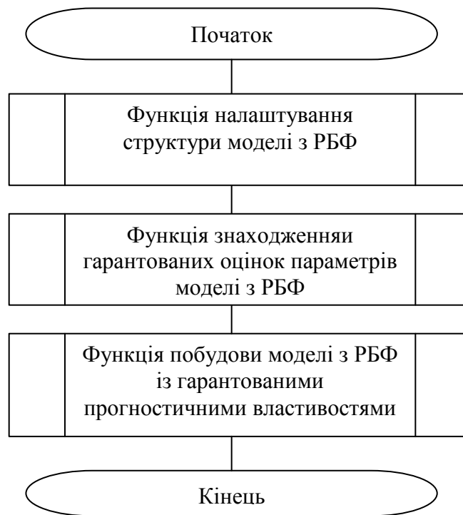
Рис. 3.7. Алгоритм функціонування програмного модуля побудови інтервальної моделі з РБФ
