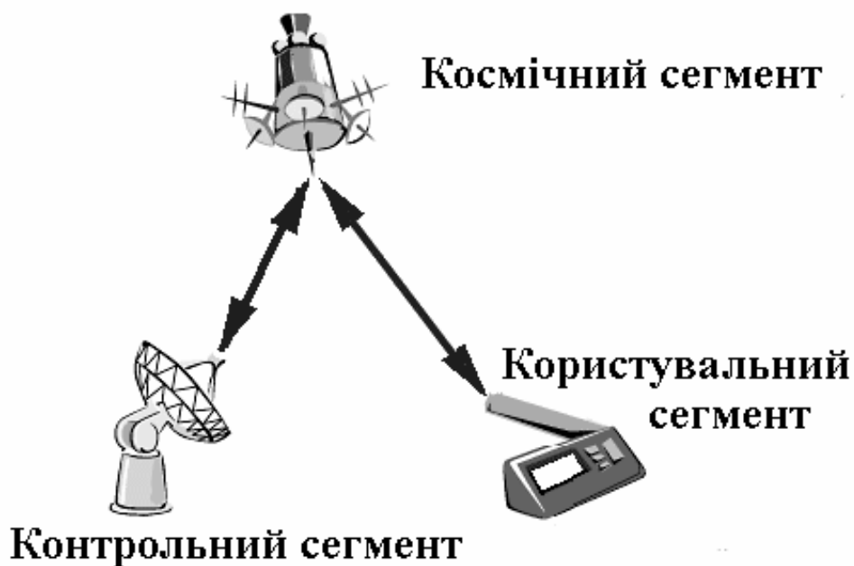
Рис. 4.1. Складові частини системи GPS.
