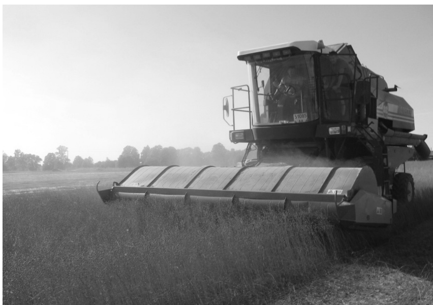
Рис. 1. Зернозбиральний комбайн «ПАЛЕССЕ GS812» з жнивarkою обчісуючого типу «СЛАВ'ЯНКА УАС-5» в роботі
