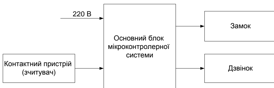
Рисунок 1 – Загальна структура мікроконтролерної системи
