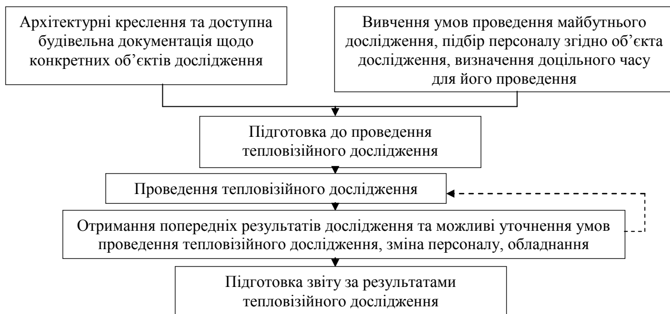
Рисунок 2 – Загальна процедура тепловізійного дослідження
