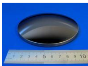
Рисунок 3.4 – Германієва захисна меніскова лінза [113]
