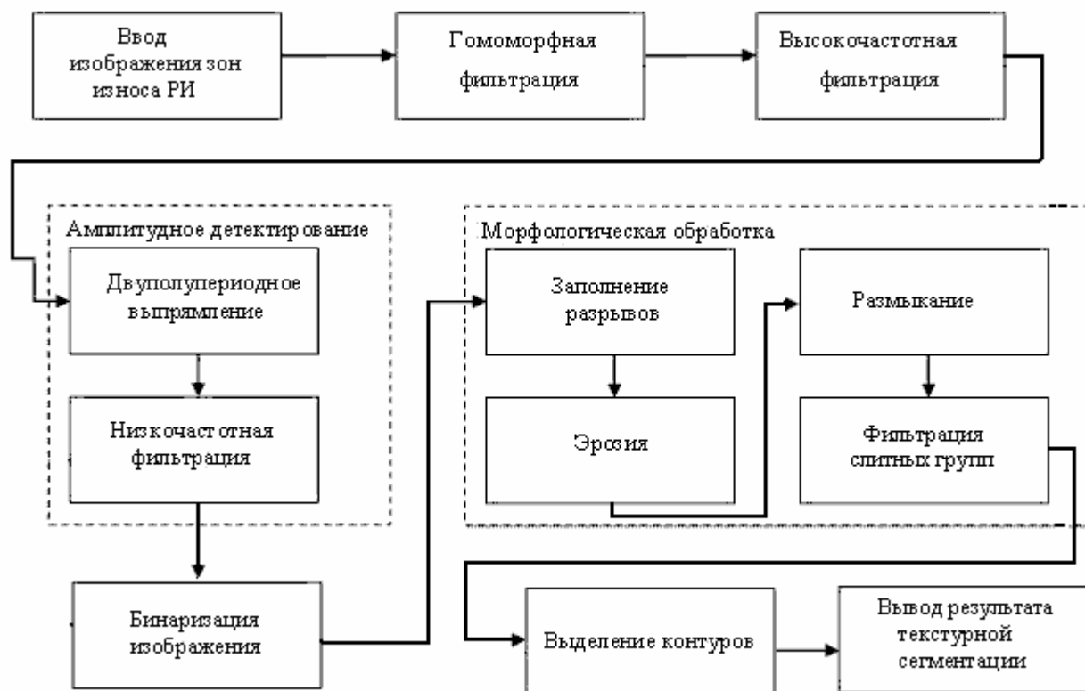
Рис. 5 – Функциональная схема амплитудно-детекторного метода текстурной сегментации изображений зон износа РИ
