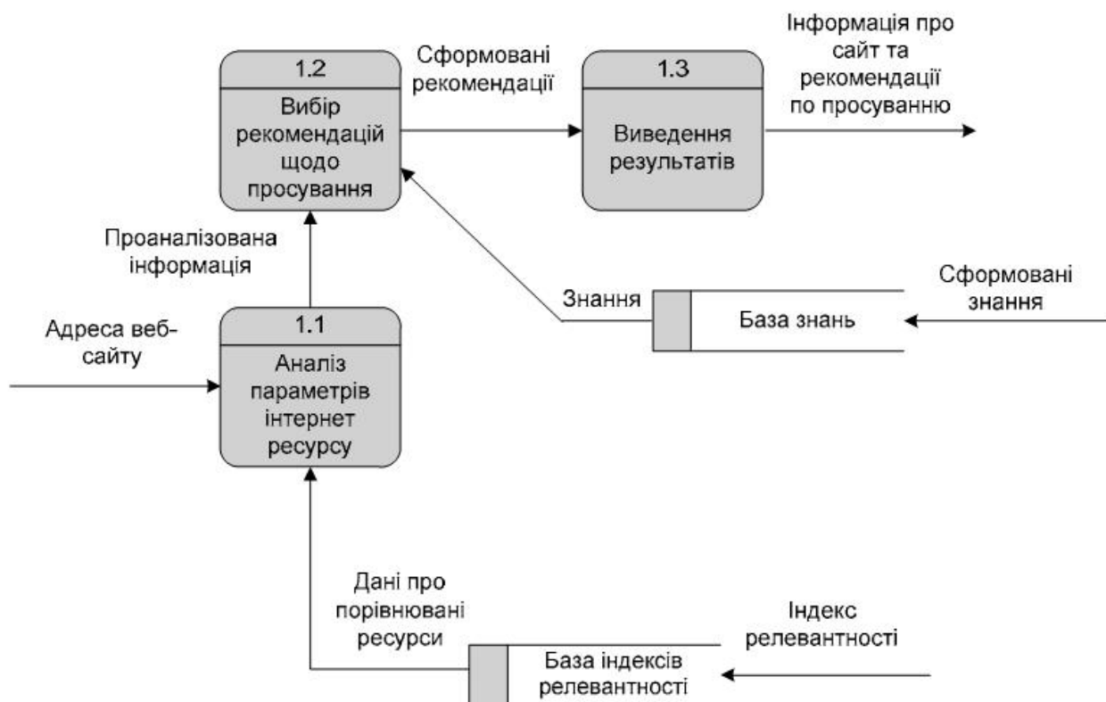
Рис. 2.4. Декомпозиція діаграми потоків даних
