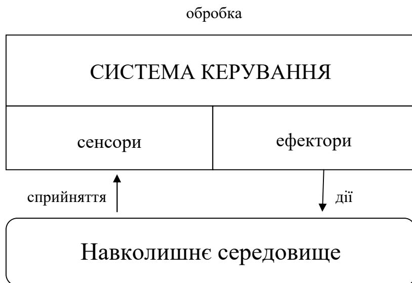
Рис. 1. Базові елементи роботизованої системи
