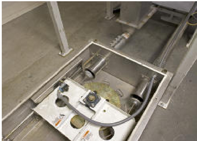
Рисунок 1.15.Конструкції привідної станції фірми CABLEVEY
