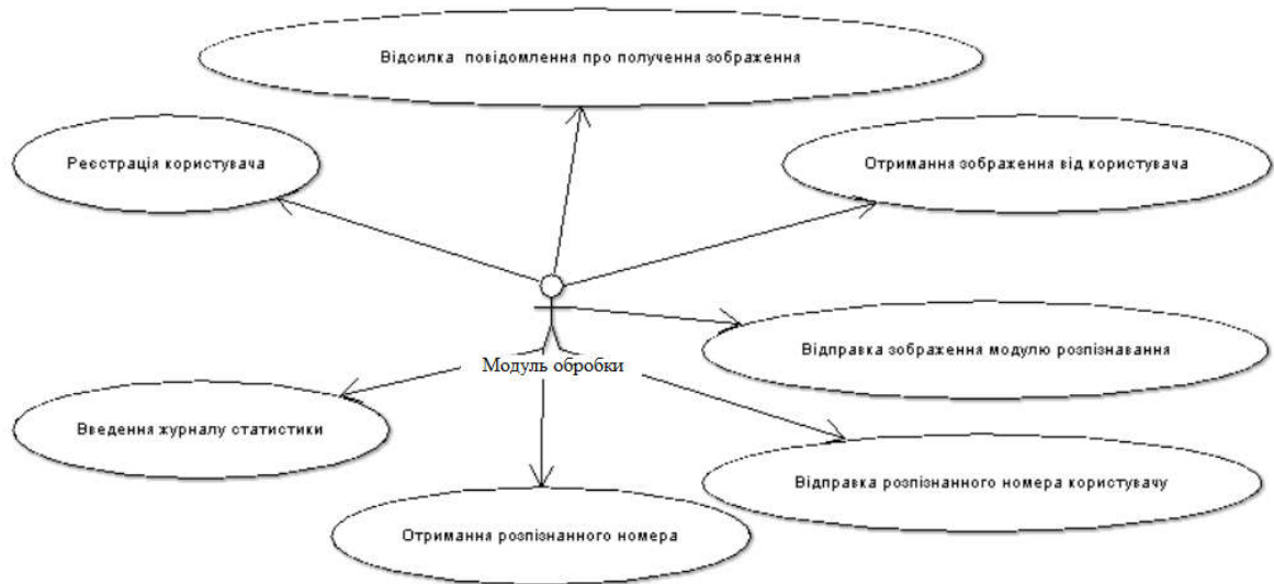
Рисунок 3.3 – Діаграма варіантів роботи модуля обробки даних
