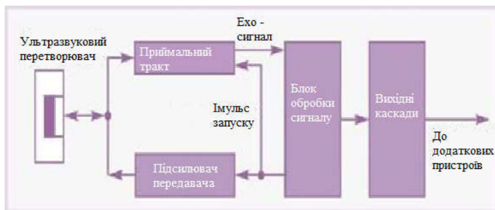
Рисунок 2.2 – Функціональна схема ультразвукового датчика з суміщеними випромінювачем і приймачем
