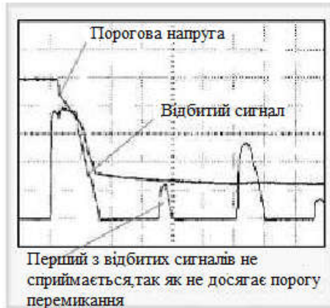
Рисунок 2.3 – Придушення завад від збурюючих об'єктів за допомогою регульованого порогу перемикання
