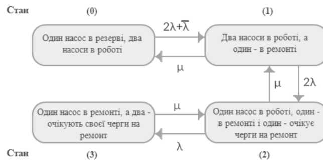
Рис. 3 Граф переходів при резервуванні заміщенням за схемою «2 з 3»
