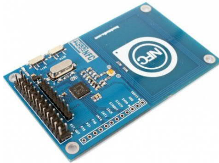
Рисунок 1.2 – RFID модуль на базі PN532
