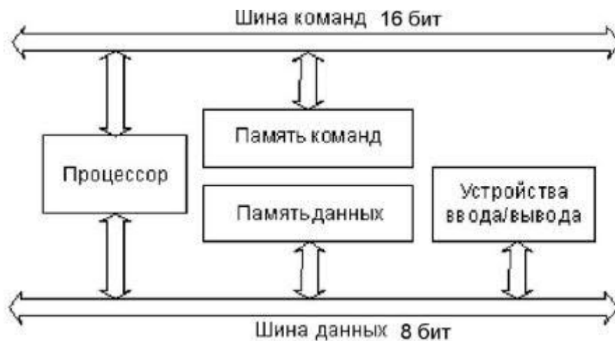
Рисунок 2.1 – Принцип роботи гарвардської архітектури в мікроконтролері ATmega328
