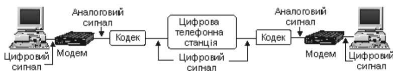
Рисунок 1.4 - Підключення через модем та цифрову телефонну станцію
