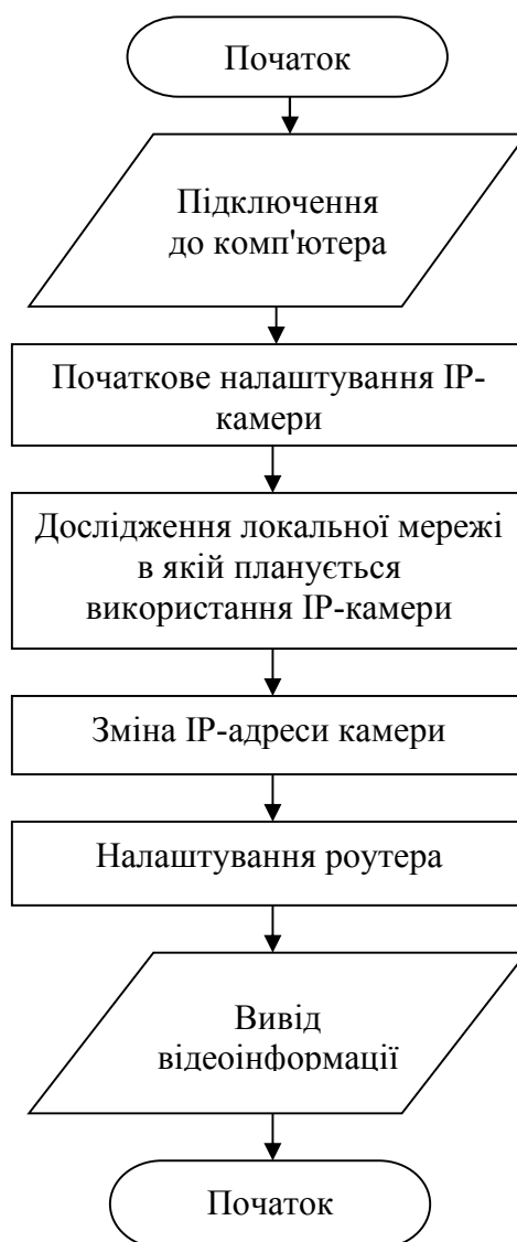
Рисунок 3.1 – Алгоритм налаштування IP-камери
